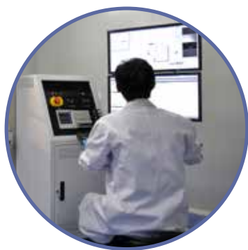
超速流式细胞分析分选平台 The BD Influx™ high-speed cell sorter
